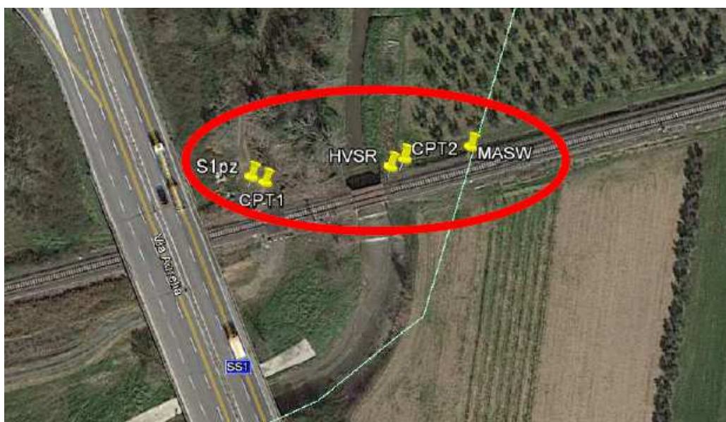
Figura 4 - Ubicazione delle indagini geognostiche
